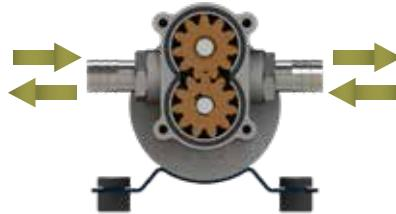
**IT** Elettropompe ad ingranaggi in bronzo per travaso di oli lubrificanti o di liquidi viscosi. Gli ingranaggi elicoidali in bronzo garantiscono pressione costante, cicli di lavoro prolungati, maggiore silenziosità e possono operare anche in mancanza di liquido. Corpo in ottone nichelato, albero in acciaio inossidabile. Tenute in FKM e O-ring in NBR. Disponibili in versioni con interruttore o deviatore integrati, kit con interruttore cavi e pinze per batteria e kit con controllo elettronico.
