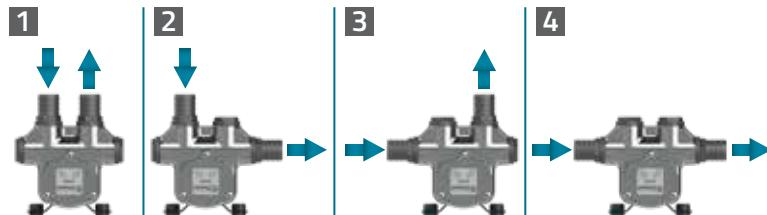
**IT** Elettropompe autoadescanti a palette, complete di valvola by-pass integrata. Le palette garantiscono alta portata e cicli di lavoro prolungati. Corpo in alluminio con doppia possibilità di connessione per portagomma. Rotore e palette in resina. Albero in acciaio inossidabile. Tenute in FKM e O-ring in NBR. Calotta motore con filtro EMI. Disponibile anche dotata di carter con maniglia per facile trasporto, interruttore on-off e pinze per batteria.
