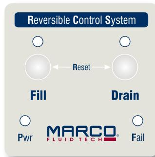
**IT** Il pannello di controllo RCS, integrato nelle pompe e nei sistemi di travaso e cambio olio, permette di monitorare il funzionamento della pompa ed interagire con essa. Caratteristiche:
