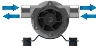
**IT** Elettropompe autoadescenti con girante flessibile in gomma. La girante in gomma garantisce alta portata e permette il passaggio di piccole impurità contenute nelle acque grigie. Disponibili con portate da 28 l/min a 45 l/min e in versioni con interruttore o deviatore integrati. Dotate di portaspazzole interno con filtro antistallo EMI, calotta impermeabile e passacavo stagno. Corpo in ottone nichelato, albero in acciaio inossidabile. Tenute in FKM e O-ring in NBR. ISO 8849 e ISO 8846.
