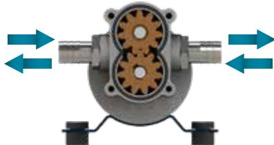
**IT** Elettropompe autoadescenti di dimensioni compatte con ingranaggi in bronzo per travaso diesel. Gli ingranaggi elicoidali in bronzo garantiscono pressione costante, cicli di lavoro prolungati, maggiore silenziosità e possono operare anche in mancanza di liquido. Corpo in ottone nichelato, albero in acciaio inossidabile. Tenute in FKM e O-ring in NBR. Disponibili in versioni dotate di carter con maniglia, interruttore o deviatore integrati e controllo elettronico.
