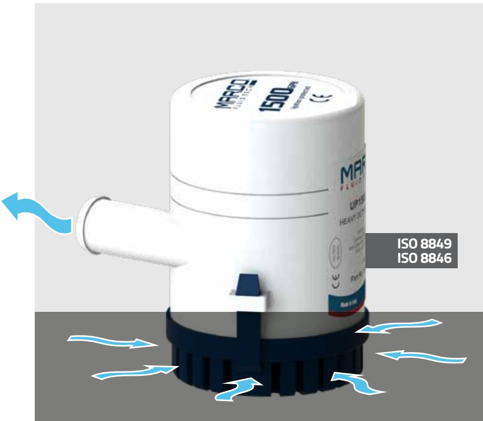
**IT** Elettropompe ad immersione per svuotamento ad alta portata e bassa prevalenza. Involucro in robusto ABS antiurto, resistente alla corrosione ed alla elettrolisi.
