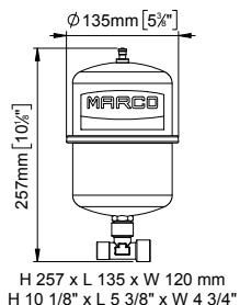
**IT** Vasi ad espansione in acciaio inox per pompe automatiche. Attacco in acciaio inox. Membrana in gomma per liquidi alimentari.
